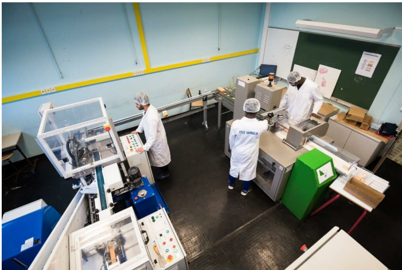
Stagiaires en Bac Pro Pilote de Ligne de Production au GPI2D s'exerçant sur une ligne d'ensachage de savonnettes au lycée Vauquelin.
