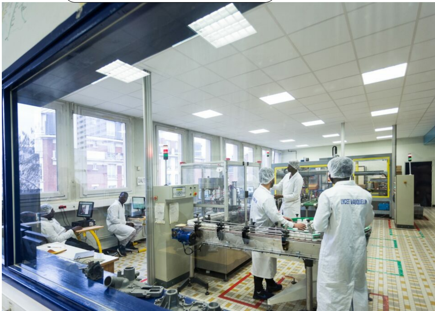
Ligne de conditionnement de liquide pulvérisant en flacons groupés en cartons, rangés sur une palette.
