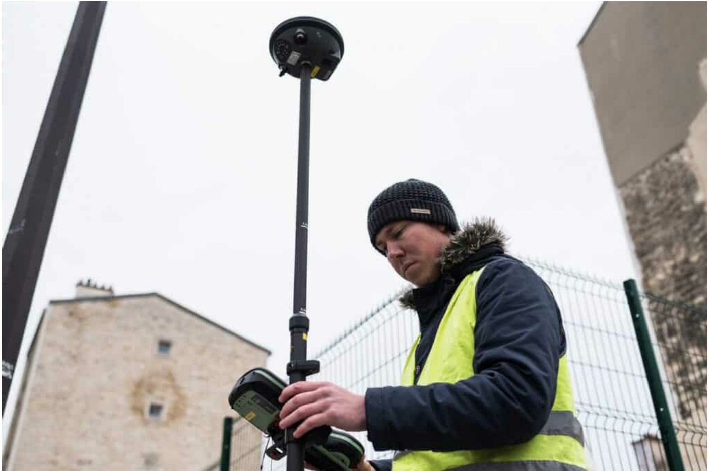
Utilisation d'un GNSS - mesures acquises à partir de données satellitaires, par un stagiaire géomètre-topographe.
