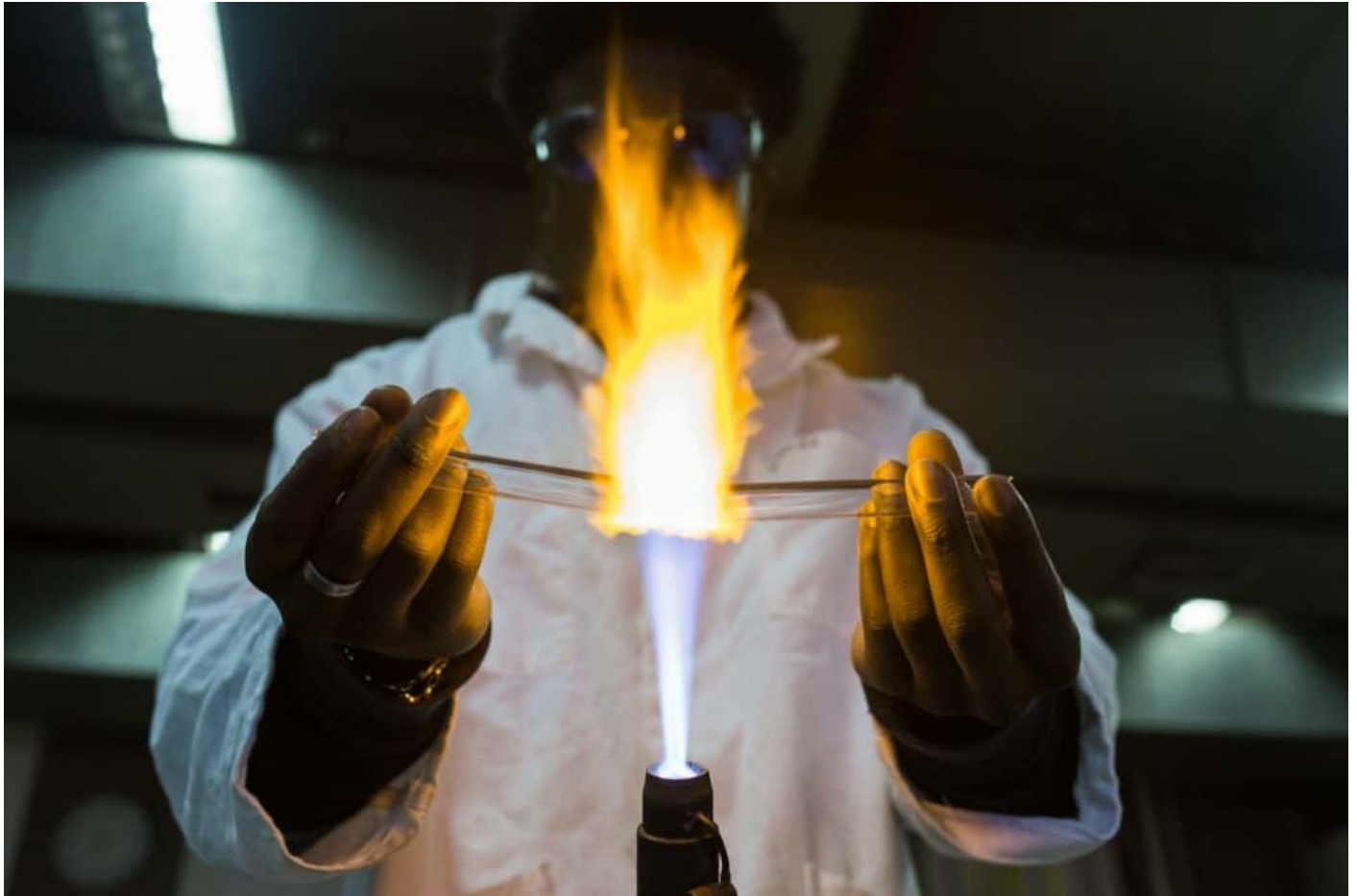
Formage d'un angle au chalumeau en atelier néon.
