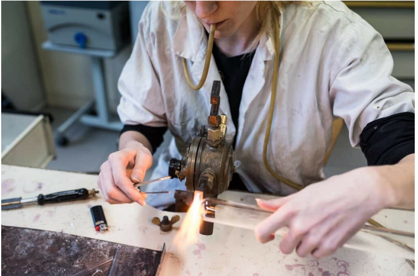
Stagiaire souffleur de verre réalisant un fond rond sur un tube de diamètre 28.
