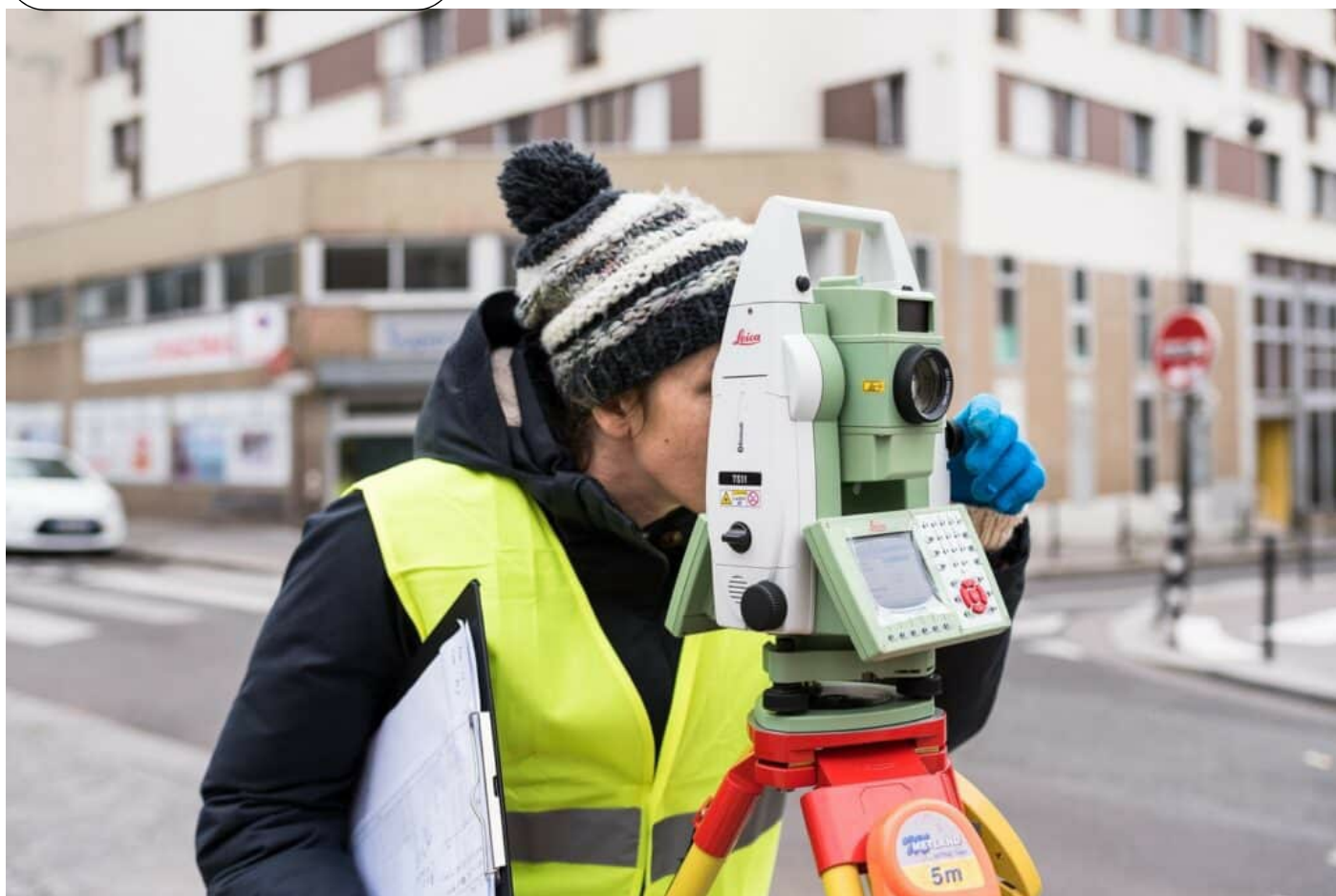
Stagiaire géomètre-topographe utilisant un tachéomètre - ou station totale - permettant de relever les mesures du terrain.
