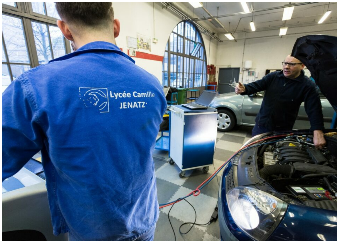
Mise en situation d'une recharge de climatisation dans l'atelier de mécanique automobile du lycée Jenatzy.
