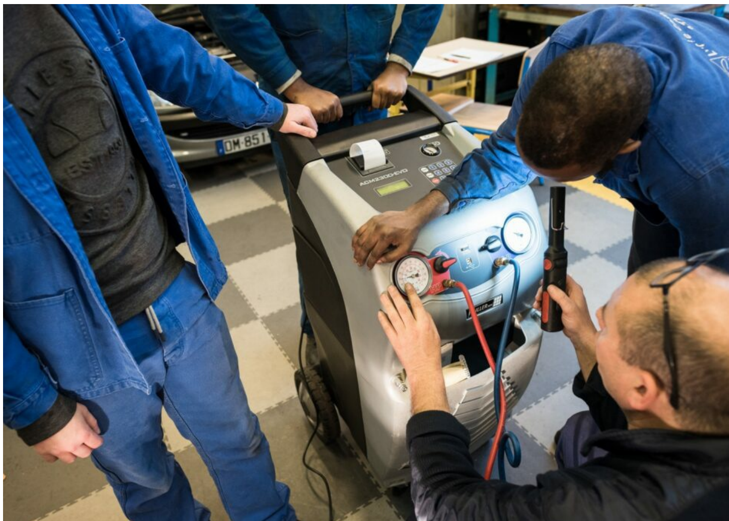
Recharge d'une climatisation à l'aide d'un appareil de climatisation.
