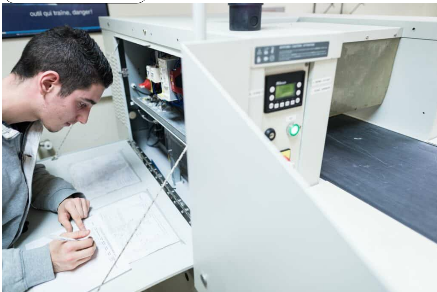
Réalisation d'un diagnostic sur le système déchiqueteuse par un stagiaire du BTS Maintenance des systèmes.
