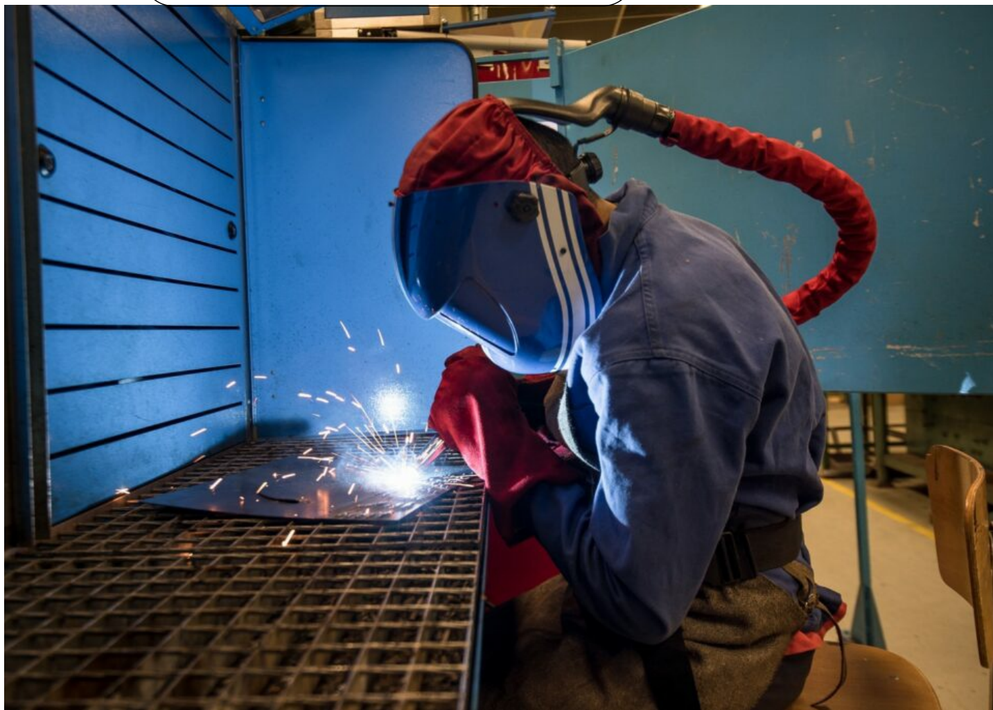
Soudage en position à plat avec cagoule système actif d'aspiration des fumées de soudage.
